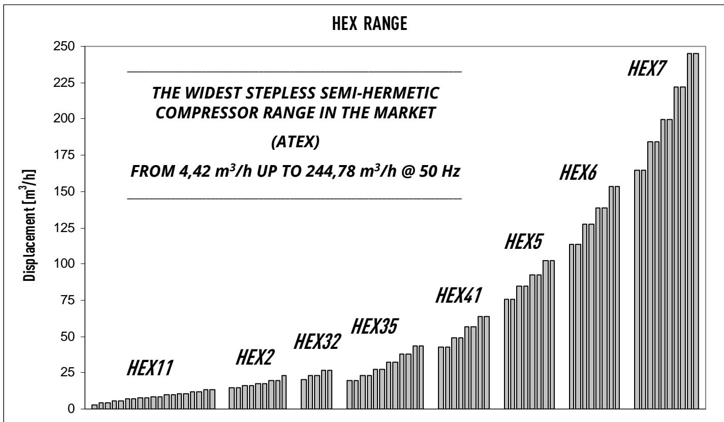
I motocompressori della serie HEX sono macchine progettate in accordo ai requisiti di sicurezza previsti per l'uso in zona classificata per presenza di gas infiammabili (zona 2, gruppo di gas IIB) secondo la Direttiva ATEX 94/9/CE e utilizzano componenti elettrici conformi alla Direttiva ATEX 94/9/CE (escluso INT69 e CPM3).
